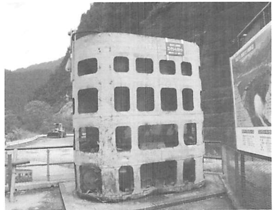
写真-4 コンクリートバケット
