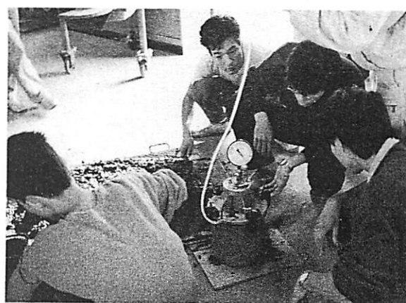
材料実験…フレッシュコンクリートの空気量試験
