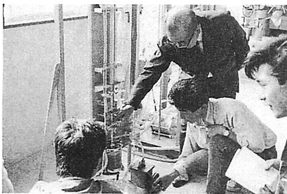
土質工学実験…変水位透水試験
